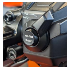
Ties „4-WD“ padėtimi išspausdintas centrinis mygtukas - blokuojamas priekinis diferencialias
