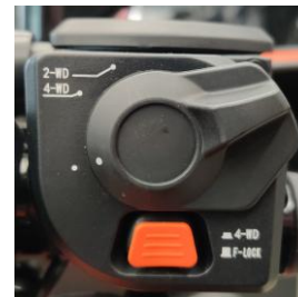
Paslinkus apsauginį dangtelį ir atspausdus oranžinį mygtuką blokuojamas priekinis diferencialas
