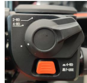
Paslinkus apsauginį dangtelį ir atspaudus oranžinį mygtuką blokuojamas priekinis diferencialas
